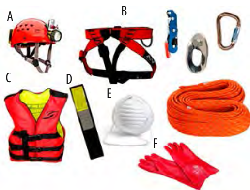
Figura 15.12. Equipamiento utilizado en espeleología: A. Casco, B. Equipos para progresión vertical, C. Chaleco salvavidas, D. Señales lumínicas o balizas, E. Tapaboca o nasobuco y F. Guantes.
