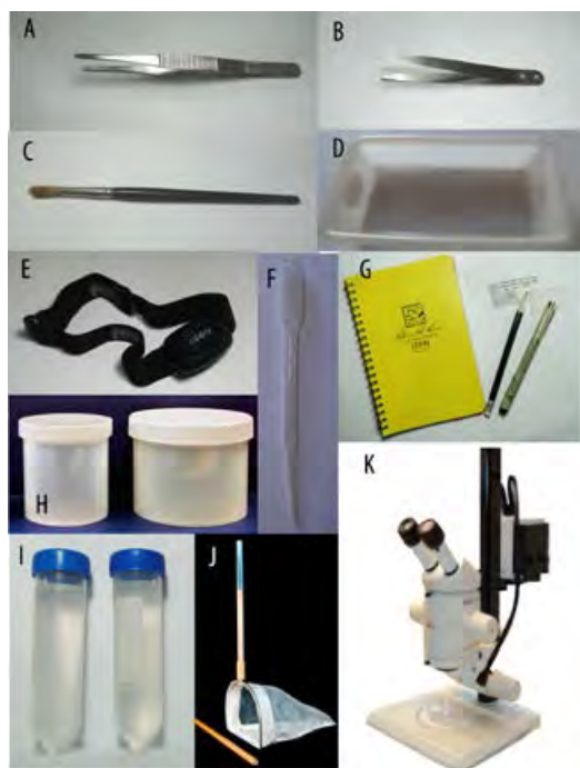
Figura 15.4. Instrumental a emplear en los muestreos y estudio de los invertebrados de las cuevas. A. pinza metálica de punta estriada (8 a 15 cm de largo); B. Pinza metálica suave (10 cm de largo); C. Pincel (25 cm de largo); D. Bandeja plástica; E. Linterna frontal; F. Gotero; G. Libreta de campo, etiquetas de papel, lápiz o pluma estilográfica con tinta indeleble (tinta china); H. Frasco contenedor; I. Frascos con etanol; J. Red o jamo y K. Microscopio estereoscópico.
