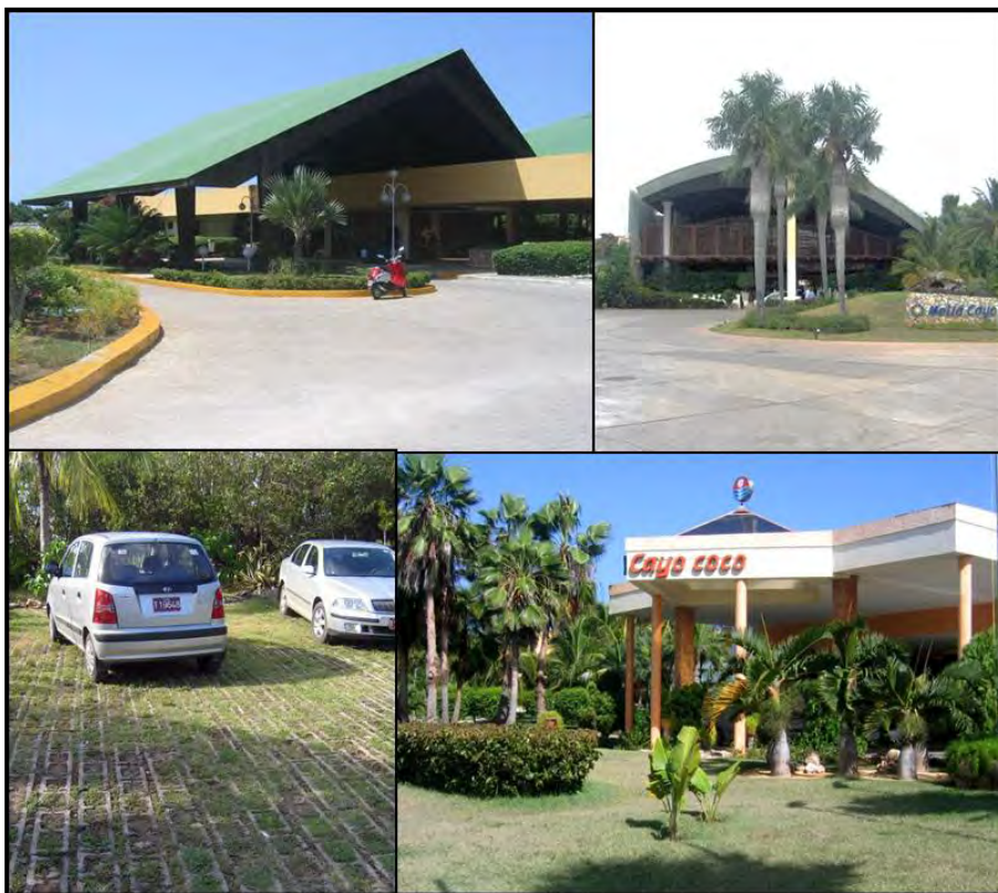
FIGURA 4.2. Zona de ingreso con motor-lobby y magnífico pavimento verde a base de adocretos con juntas libres en hoteles de la cayería. (Fotos: Sergio Ferro y Oliesky Fabre)
