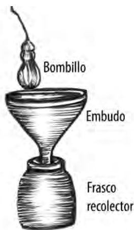
Figura 13.8. Esquema de una trampa de luz automática colgable. © G. Pineda Quiala.
