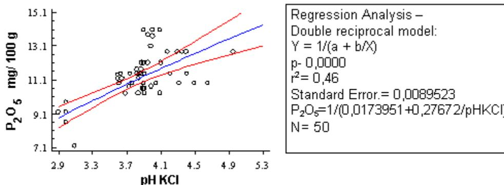
**Figura 1.** Relaciones pH KCl y P<sub>2</sub>O<sub>5</sub> mg/100 g en suelo ferralítico rojo lixiviado de montaña.
