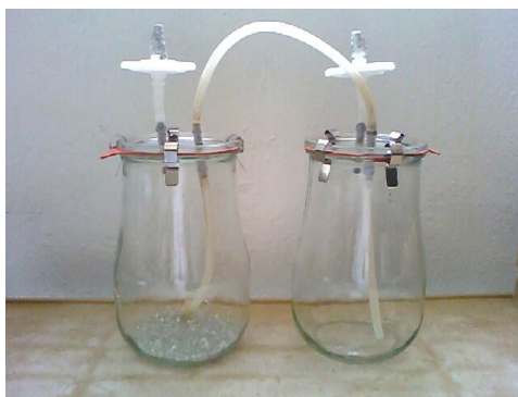
Figura 2. Sistema de inmersión temporal que se utilizó para la multiplicación de los brotes de teca ( Tectona grandis L.).
