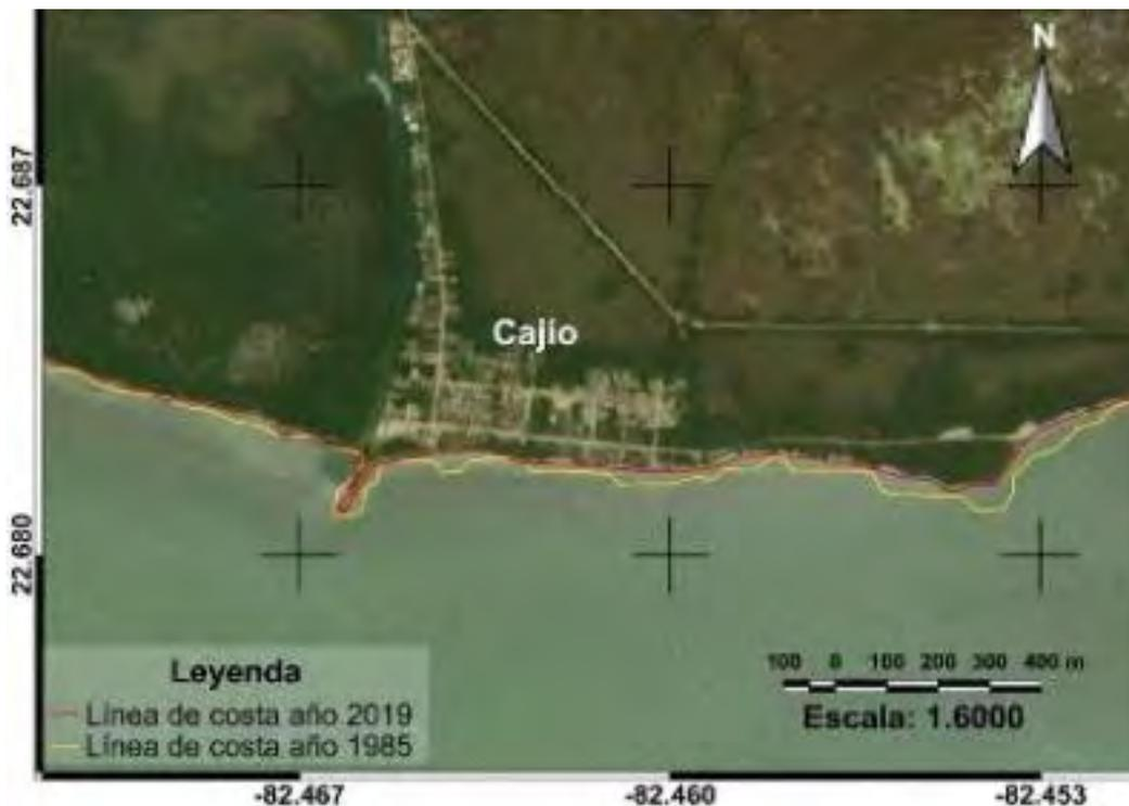
Figura 32. Desplazamiento de la línea de costa en el área de Cajío, entre 1985 y 2019, estimado mediante el procesamiento de imágenes satelitales. Las líneas de color amarillo corresponden a las imágenes de 1985 y las líneas de color rojo a las de 2019.
