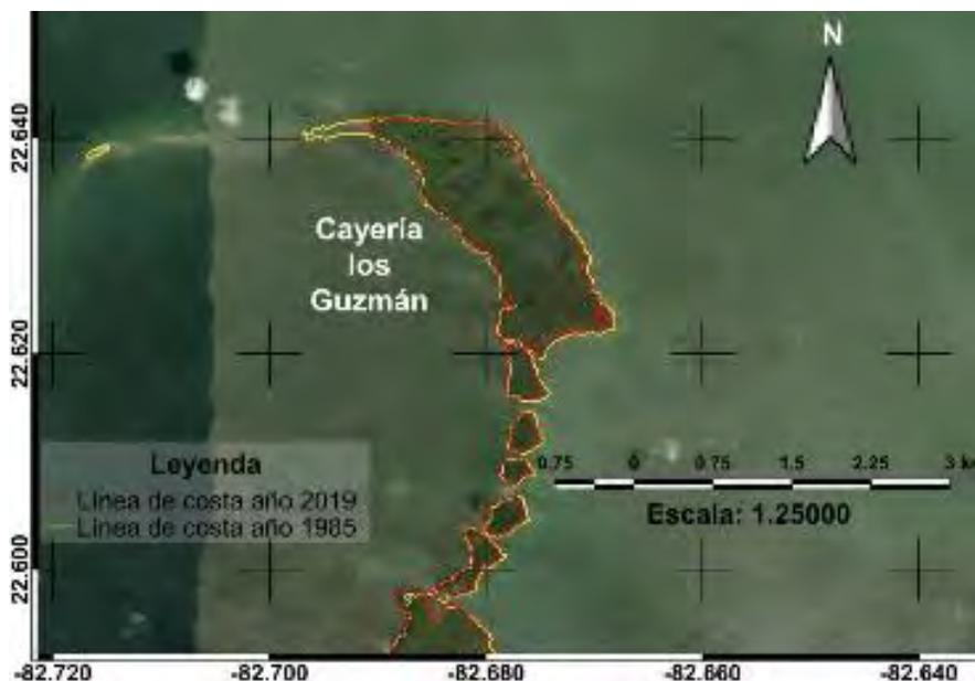
Figura 34. Desplazamiento de la línea de costa en los cayos Los Guzmanes entre 1985 y 2019, estimado mediante el procesamiento de imágenes satelitales. Las líneas de color amarillo corresponden a las imágenes de 1985 y las líneas de color rojo a las de 2019.
