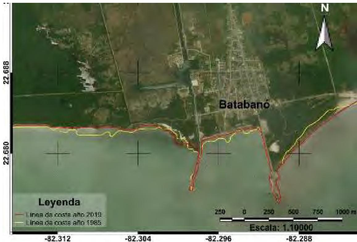
Figura 31. Desplazamiento de la línea de costa en el área del Surgidero Batabanó, entre 1985 y 2019, estimado mediante el procesamiento de imágenes satelitales. Las líneas de color amarillo corresponden a las imágenes de 1985 y las líneas de color rojo a las de 2019.
