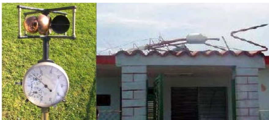
Fig. 3.4.1-1. Anemómetro manual, (izquierda) y (derecha) destruido por la fuerza del viento en la estación meteorológica de Paso Real de San Diego (Huracán «Gustav», 2008)
