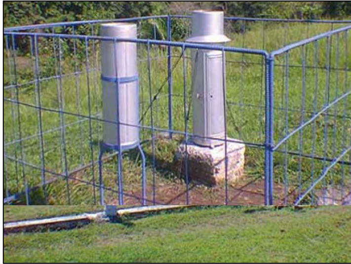
Fig. 3.6-1. Pluviómetro y Pluviógrafo operado por el INRH
