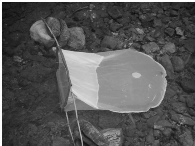
Figura 1. Red de deriva colocada en posición para capturar los macroinvertebrados en la columna de agua un afluyente del río Bayate, Sierra del Rosario, Cuba.
