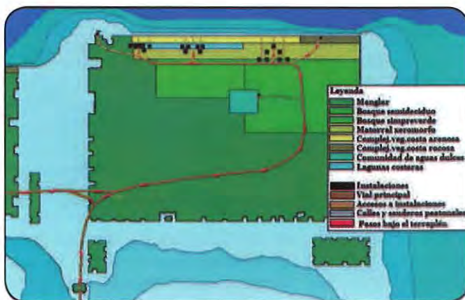
FIGURA 3. Esquematización de trazado y tratamiento vial en un cayo hipotético. Se indica alternativa para evitar la afectación de la estrecha faja del matorral xeromorfo costero, prefiriendo emplazar el vial sobre los bosques micrófilo y semideciduo, mucho más resistentes. Se señalan los pasos de aguas y terrestres por debajo de la red vial tanto vehicular como peatonal (en rojo). Nótese que esta alternativa disminuye la marginación de las áreas de vegetación cortadas por el vial (Foto Sergio Ferro)
