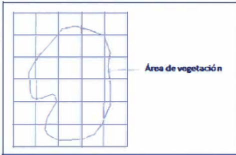
Fig. 3. Esquema que ilustra el uso de papel cuadrulado para el cálculo del área de ocupación de la población de Eichhornia crassipes .
