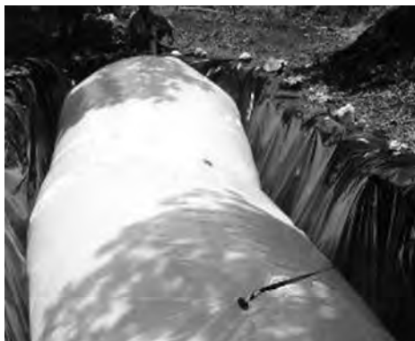
Figura 3. Digestor de manga de polietileno o bolsa de nylon.
