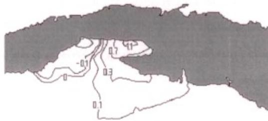
Fig. 7. Ejemplo del campo de la surgencia obtenido por el modelo para una tormenta tropical que ha penetrado perpendicularmente a la costa sur de las provincias habaneras, con una presión central mínima de 999 hPa, viento máximo de 100 km/h, radio de viento máximo 25 km y velocidad de traslación de 18 km/h.
