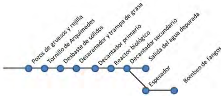
Figura 2 Esquema de los procesos de tratamiento en la EDAR de Montcada i Reixac (Sasa, 2014).
