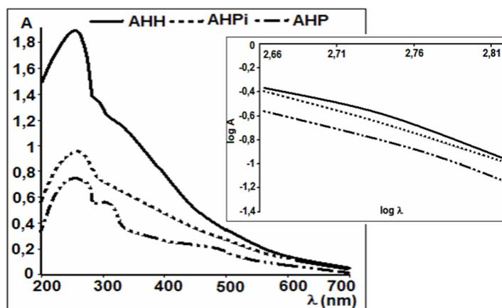
Figura 2. Espectros UV-vis y gráfico de inclinación (460–660 nm), de los AHs obtenidos con los diferentes extractores.
