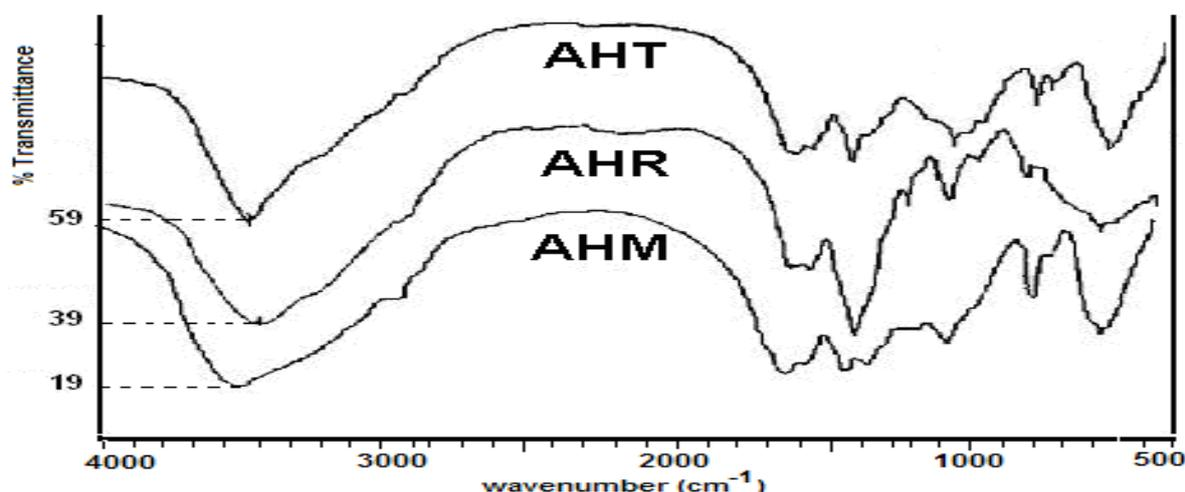
Figura 3. Espectros FTIR de los AHs extraídos mediante los diferentes procedimientos.
