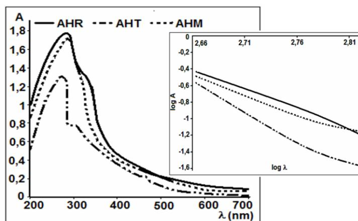
Figura 4. Espectros UV-Vis y gráfico de inclinación (460–660 nm) de los AHs purificados con diferentes procedimientos.
