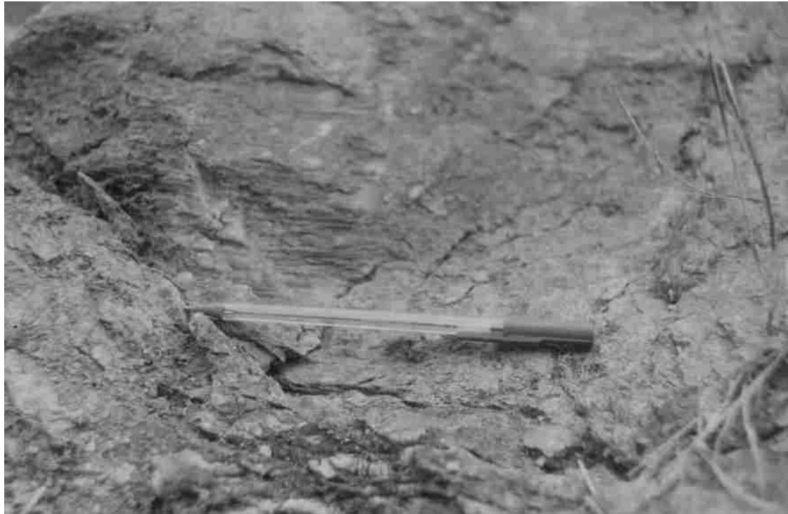
Figura 2. Abundantes escamas de calcita y estrías, que señalan la dirección de los desplazamientos (sinestrales) en un plano de la zona de falla Pinar, localizado en calizas pertenecientes a la Formación Artemisa, a 6 km de la ciudad de San Cristóbal por la carretera a Bahía Honda (Pto. N° 64).
