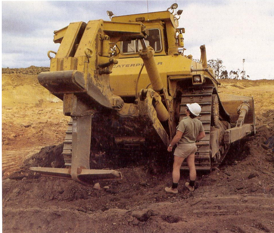
Figura IV.11. Subsolador de alta potencia. (Environment Australia 1997)
