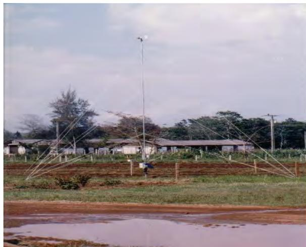
Fig. V.3. Estación meteorológica automatizada. (Pinares S. A.. 1998).
