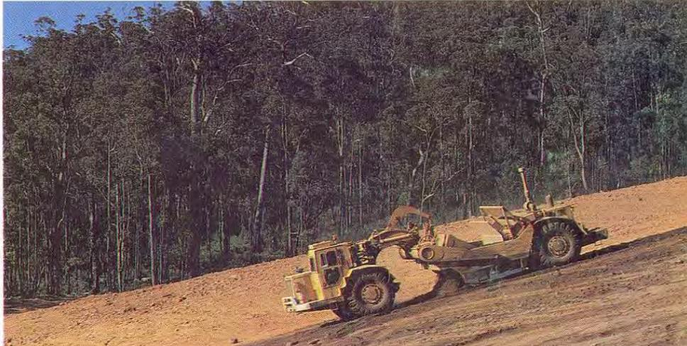
Fig. V.23. Mototrailla (pala transportadora) para destape, traslado y deposición de la capa vegetal. (Environment Australia, 1997)
