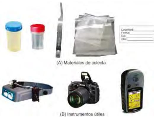
Figura 11.7. Materiales e instrumentos útiles en los muestreos. A. Viales, pinza, bolsas de nylon y etiquetas; B. Optivisor, cámara fotográfica y GPS.
