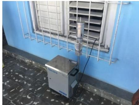
Figura 3. Captador Tecora de bajo volumen PM<sub>10</sub> a 38,3 L/min
