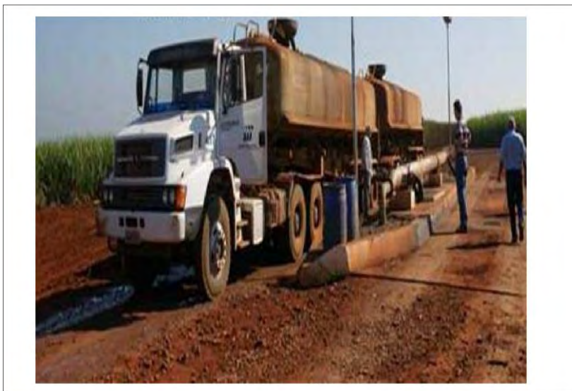
Figura 9.1. Camión con dos cisternas, utilizado en Brasil para aplicar los residuos de las destilerías de alcohol en los campos de caña de azúcar, cargando la vinaza en el punto de abastecimiento del embalse. Actualmente Cuba está adquiriendo equipos de este tipo para usarlos en el riego de residuales.
