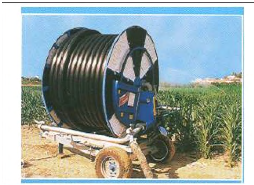
Figura 10.8. Enrollador utilizado para realizar el riego por aspersión en la caña de azúcar.
