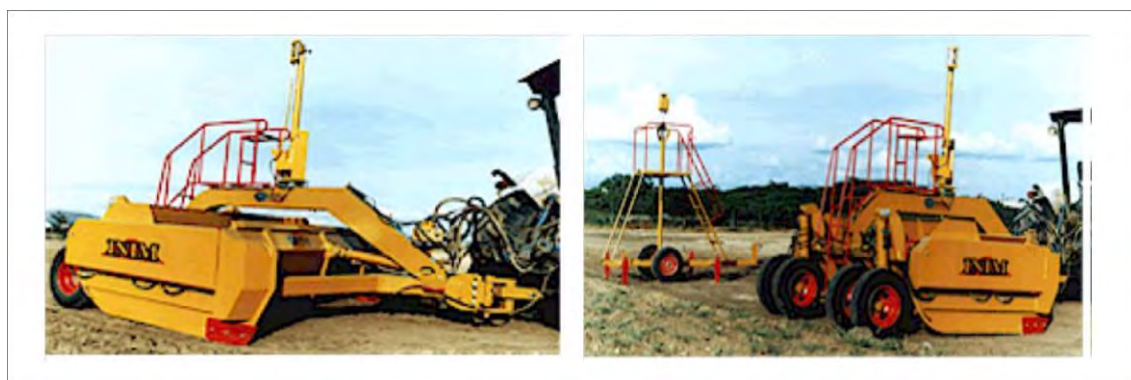
Figura 10.12 Niveladora láser con eyector. A. Modelo NLE-10 con compuerta. B Modelo NLE-10 con tráiler para transmisor láser. El diseño de esta generación de niveladoras permite cortar, cargar y transportar la tierra.
