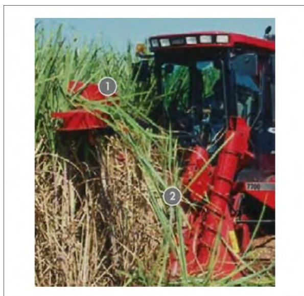
Figura 11.6. Cosecha de caña verde utilizando la cosechadora CASE 7000, nótese el tamaño de la caña y el volumen de paja, 1 Triturador de cogollo, 2 Cuchilla de corte lateral.
