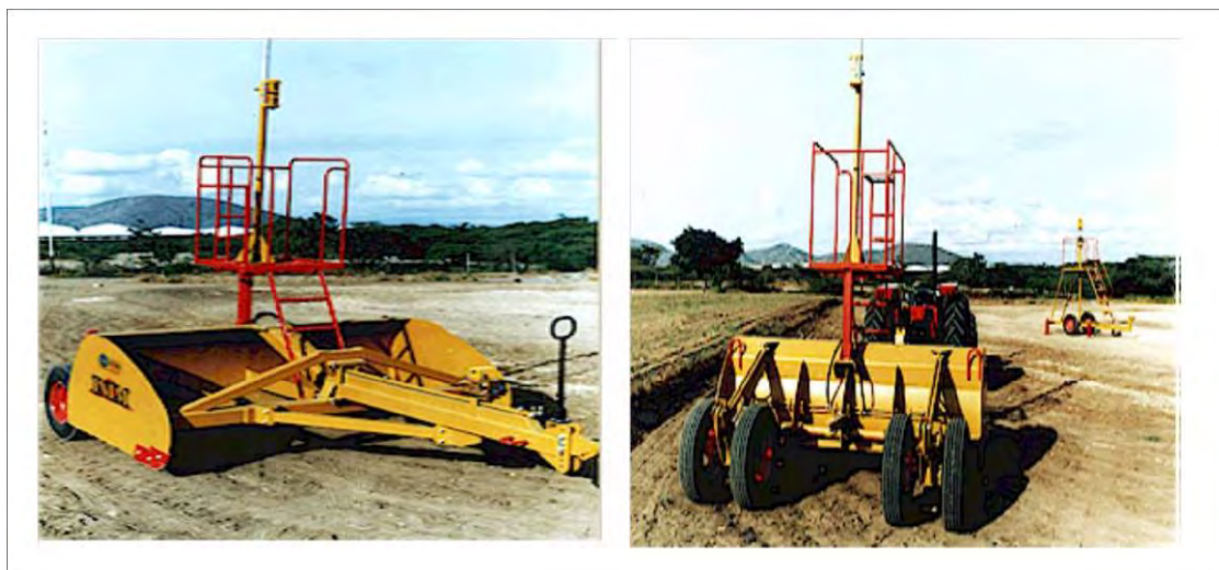
Figura 10.13. Alisadoras láser sin eyector. A. Modelo AI-10. B. Modelo AI-10 con tráiler para transmisor láser, diseñadas especialmente para operaciones finales de remodelación de un campo y para mantenimiento de áreas micro-niveladas.
