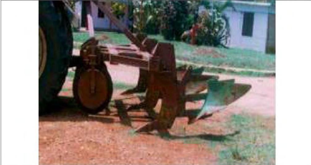
**Figura 6.3. Subsolador surcador Bayamo 95. Es utilizado para la labranza combinada de dos surcos simultáneos, permitiendo realizar la plantación inmediatamente después de la labor; además se logra mantener la equidistancia entre surcos.**
