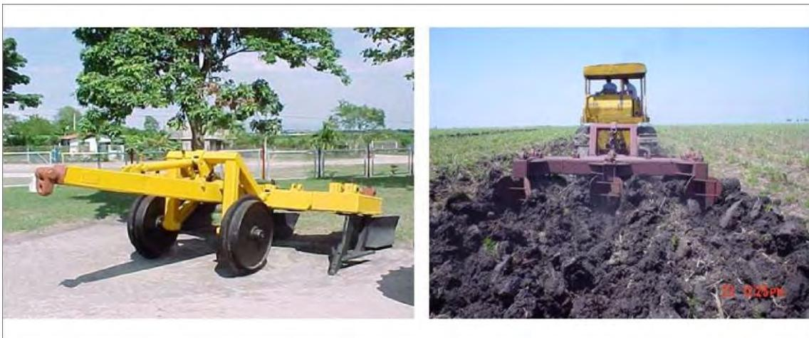
**Figura 6.4. Subsolador descepador SP 320 para laborar tres surcos a la vez en un solo pase del equipo, con lo que se ahorran considerablemente el número de labores y el tiempo de preparación del suelo.**
