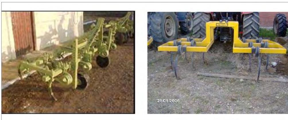
**Figura 6.9. Cultivadores de ganchos utilizados para el control mecánico de malezas en la caña de azúcar.**
