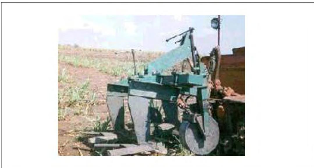
**Figura 6.1. Multiarado MAU 250 C fabricado en Cuba, utilizado en la preparación de suelos sin inversión del prisma.**
