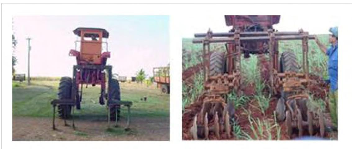
**Figura 7.10. Tractores de alto despeje utilizados para realizar cultivo de desyerbe en plantaciones de caña de azúcar de mayor tamaño.**
