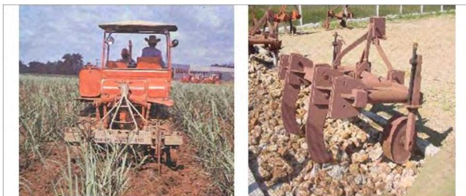
**Figura 6.13. Labor de descompactación profunda con tractor DT-75 y vista lateral del implemento utilizado.**
