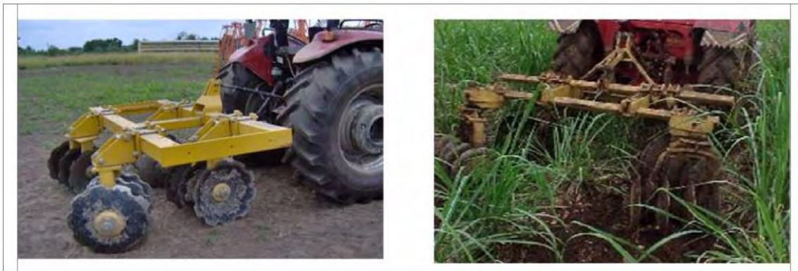
**Figura 6.15. Cultivadores de discos utilizados para el aporque y acondicionamiento del terreno para la cosecha de la caña de azúcar.**
