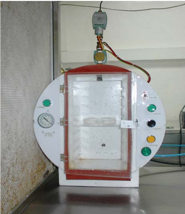
Figura 3. Pistola de genes (CINVESTAV) de baja presión empleado para la transformación genética de suspensiones celulares del cultivar híbrido de plátano 'FHIA-21' ( Musa sp. AAAB).
