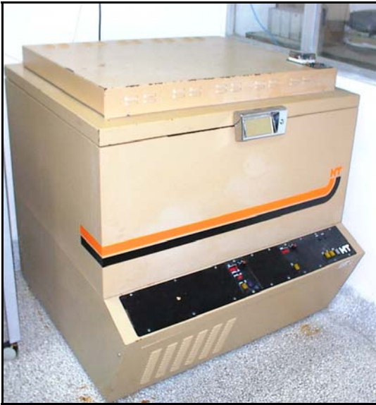
Figura 2. Agitador orbital modelo INFORS utilizado para el establecimiento y multiplicación de las suspensiones celulares del cultivar híbrido de plátano 'FHIA-21' ( Musa sp. AAAB).
