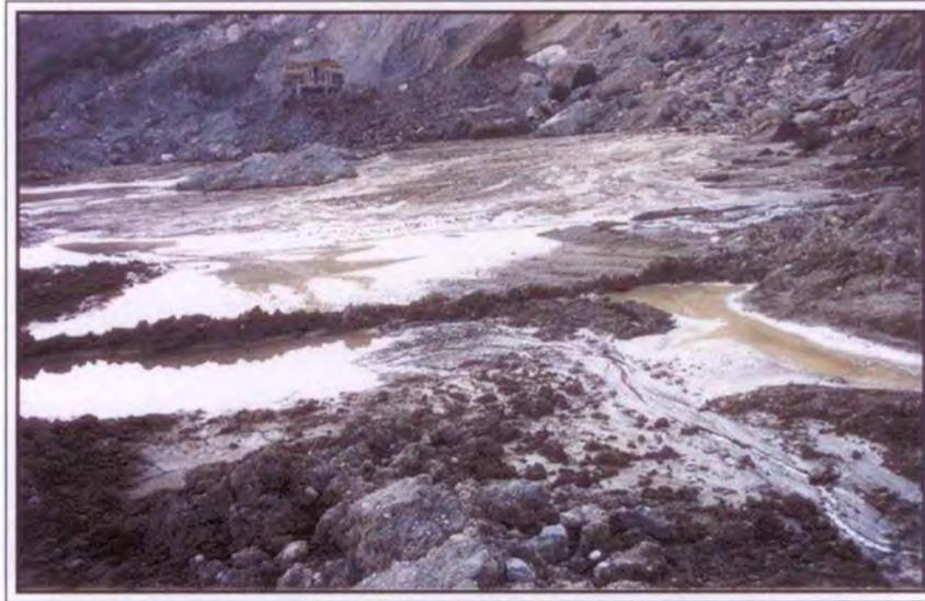
Figura 39. Encharcamiento en la cantera en explotación.
