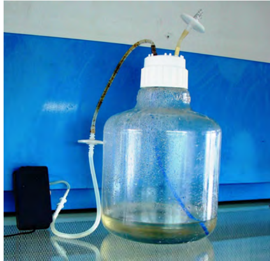
Figura 3. Sistema de inmersión constante con aeración mediante burbujeo continuo en el medio de cultivo.
