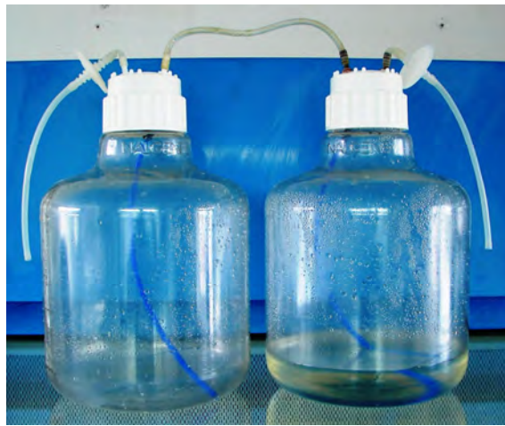
Figura 2. Sistemas de inmersión temporal empleados en este trabajo.
