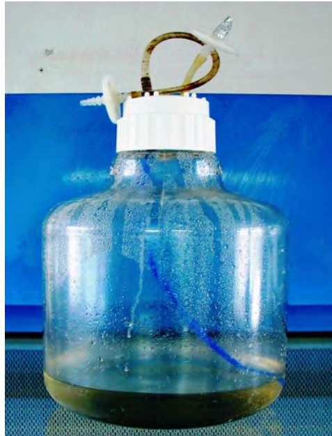
Figura 4. Frasco de cultivo con el medio de cultivo líquido estático con renovación pasiva de la atmósfera interna.
