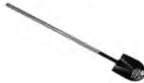
**Fig. 9. Pala:** Se usa para voltear la tierra y se emplea siempre que se prepara el terreno; también se utiliza para la recogida de desperdicios y para transportar tierra.
