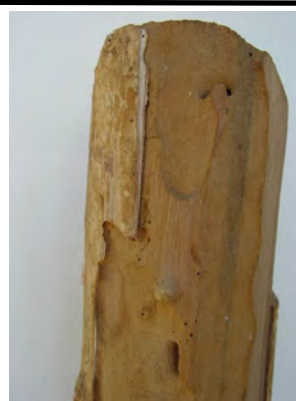
Fig. 3. Muestra representativa del daño ocasionado por termitas en la madera y corteza de Crescentia cujete (Bignoniaceae).
