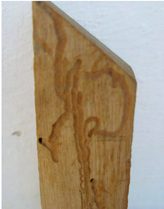
Fig 4. Muestra representativa del daño ocasionado por termitas en la madera de Erythroxylon areolatum (Erythroxylaceae).
