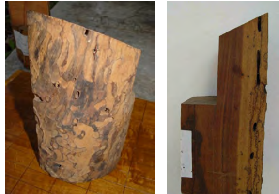
Fig. 5. Muestra representativa tomada desde diferentes posiciones, de los daños ocasionados por termitas en la madera de Cojoba arborea (Mimosaceae).
