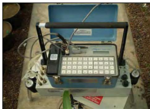
**Figura 5. Imagen del equipo portátil utilizado para medir Conductancia estomática y Tasa Fotosintética, modelo Li- 6200 (Licor, Nebraska, USA).**
