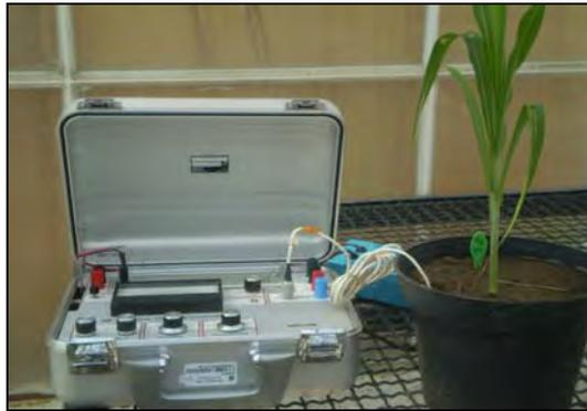
**Figura 4. Imagen del Potenciómetro portátil (HR-33T modelo Dew Point microvoltmeter WESCOR USA) utilizado para medir los potenciales hídricos**
