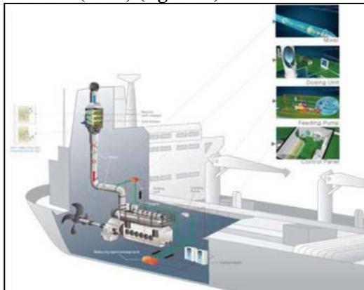
Fig. 5. Esquema tecnológico Reducción Catalítica Selectiva (SCR).
