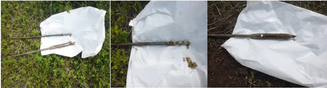
Foto N° 1. Tipos de barrena utilizadas durante los trabajos de perforación en los diferentes embalses Manicaragua, Cautillo, Cauto el Paso, Batalla de Guisa, Rincón, Chimbi y Playuela. Barrena Helicoidal (arriba) y Barrena Toma Muestra (abajo).
