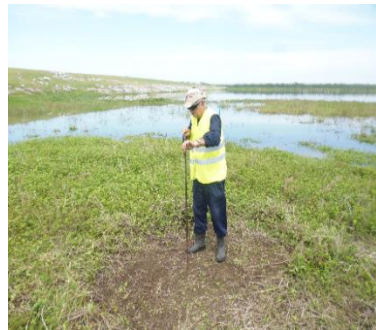
Embalse Cauto El Paso. Perforación con barrena helicoidal para determinar la profundidad del sedimento, en el Embalse Chimbi.
