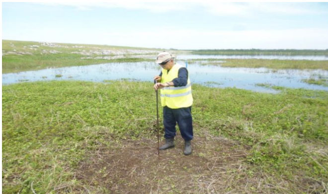
Foto N° 4. Perforación con barrena helicoidal por el Esp. Geólogo para determinar la profundidad del sedimento, en el Embalse Chimbi.
