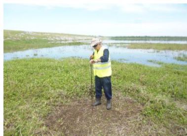
Perforación con barrena helicoidal para determinar la profundidad del sedimento, en el Embalse
