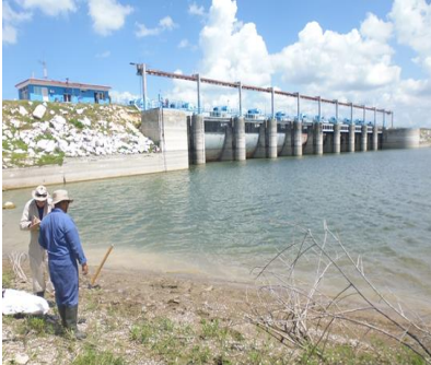
Embalse Cauto El Paso. Perforación con barrena helicoidal para determinar la profundidad del sedimento, en el Embalse Chimbi.
