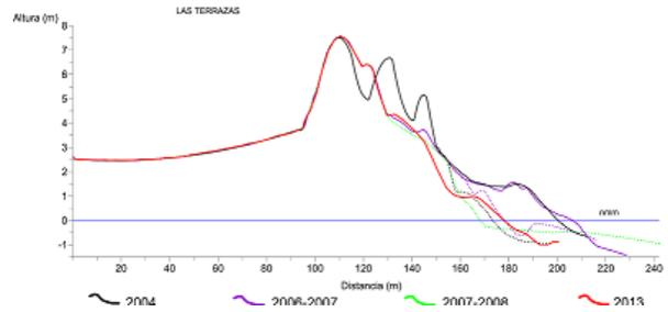
FIG. 9. Evolución morfológica del perfil de playa que evidencia un retroceso a partir del 2007 hasta el presente.
