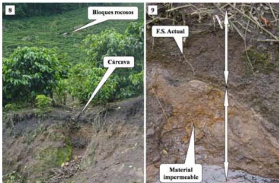
**Fotografías 8 y 9. La longitud corta de la ladera favorece la estabilidad de la formación superficial (8). Se halla sobre un depósito antiguo endurecido e impermeable (9). (Imágenes V. Cortés)**
