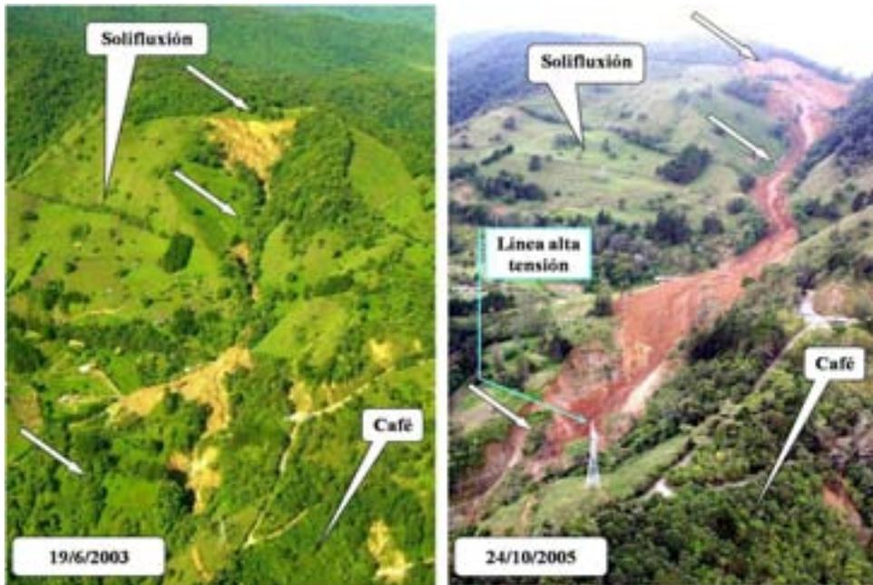
**Fotografías 6 y 7. Las flechas señalan los cambios ocurridos en la ladera entre los dos deslizamientos producidos en la microcuenca del río Granados. Nótese la vulnerabilidad a que están expuestas las líneas de transmisión eléctrica, casas de habitación, caminos y cultivos. (Imágenes CNE 2005).**
