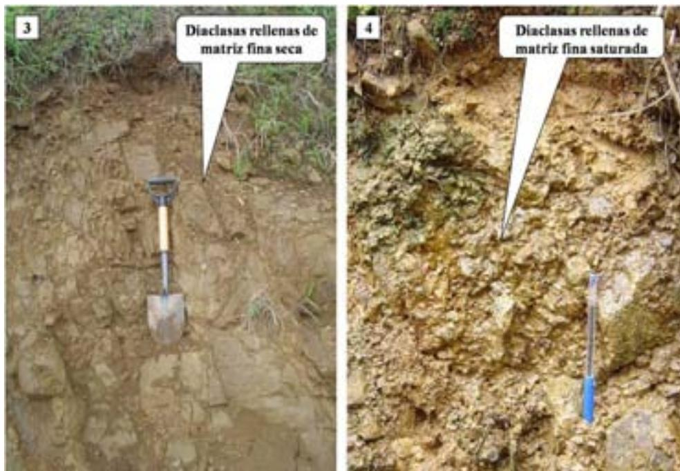
**Fotografías 3 y 4. Formación superficial de alteración in situ con aporte de materiales coluviales en superficie (3). Formación superficial deslizada de depositación caótica en media ladera (4). (Imágenes V. Cortés)**
