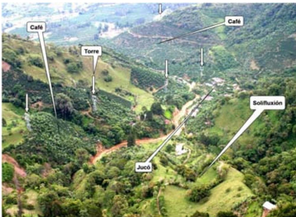
**Fotografía 10. El acarreo masivo de materiales en el cauce del Río Granados, socaba sus riberas, inestabilizando la ladera cultivada de café que alterna con pastos y manchas de bosque, así como la línea de conducción eléctrica y al poblado de Jucó (Imagen CNE 2005).**
